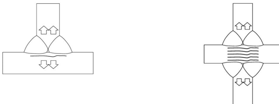
Рисунок 3.1 – Расслаивание стальных листов
