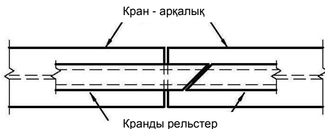
8.3 Сурет – Кран рельсінің қиғаш жігі
